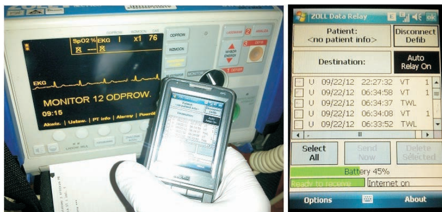
Rycina 1. Zestaw do teletransmisji zapisu EKG, używany w zespołach wyjazdowych ratownictwa medycznego.
